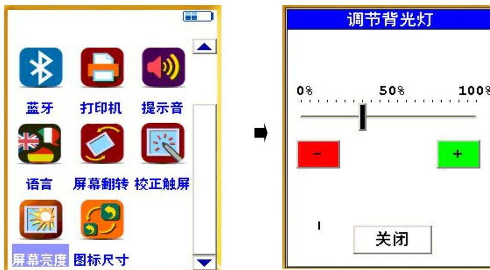
选择红色[-]键滑动条将向左移动，屏幕会慢慢变暗，选择绿色[+]键滑动条将向右慢慢移动，屏幕逐渐变亮，调节到与环境最适应的亮度，选择“关闭”将保存当前状态并返回到应用菜单。一般情况可以使用30%~50%，强光对比时可调亮屏幕，增强视觉效果。
