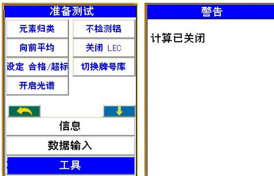
在合金分析中，当计算测试结果时，仪器对于不确定含量的轻元素通常被假定为铝，当仪器接收不到某些不能被激发的物体（如木头，塑料等）反射的X射线时，仪器也会把这些物体都误认为是铝。通过工具菜单切换选择“不检测铝”则可以在计算分析结果时不再将这些物体含量认为是铝元素含量，只显示仪器所测试的样品中各元素的含量，从而过滤掉这些物体的反射噪声，避免衬托物对分析结果的干扰。
