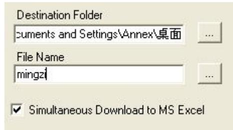
10. 设置完成后点击
