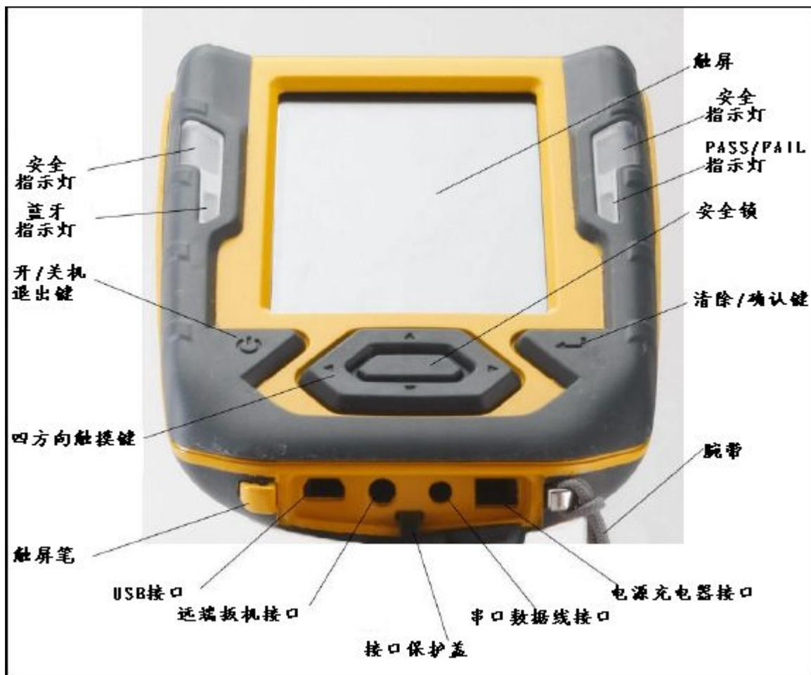
仪器的控制面板位于触摸屏下方，控制面板由一个4方向键和两个控制键组成。操作仪器时，既可以使用控制面板，也可以使用触摸屏来切换菜单，仪器还配有触屏笔。使用4方向键可以控制屏幕上的光标移动来选择菜单选项。清除/确认键位于四方向键的右侧，开机/关机/退出键位于四方向键的左侧，当按下开机/关机/退出键后马上松开时，作用就是“退出”，可以从当前菜单系统直接退回到上一级菜单。开启仪器时，需要持续按住开机/关机/退出键直至仪器上的指示灯点亮（约3秒钟），关闭仪器则需要持续按住开机/关机/退出键直至仪器关闭屏幕即可。
