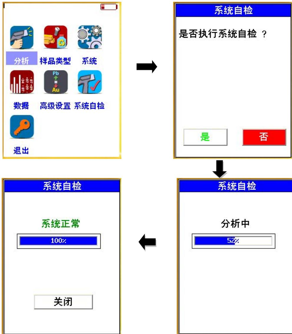
通过系统自检可自动修正环境对仪器分析结果的影响。尤其在下列情况下，建议使用仪器前先做仪器系统自检：
