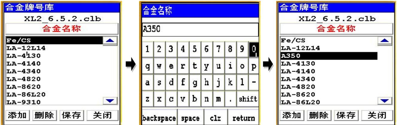
2. 在合金名称列表中选中A350，点“添加”，则屏幕显示变为下图所示，用户可以根据该牌号种各元素的含量范围修改右侧“Min”与“Max”中的数值，对于无要求的元素数值可以保持为“0”。
