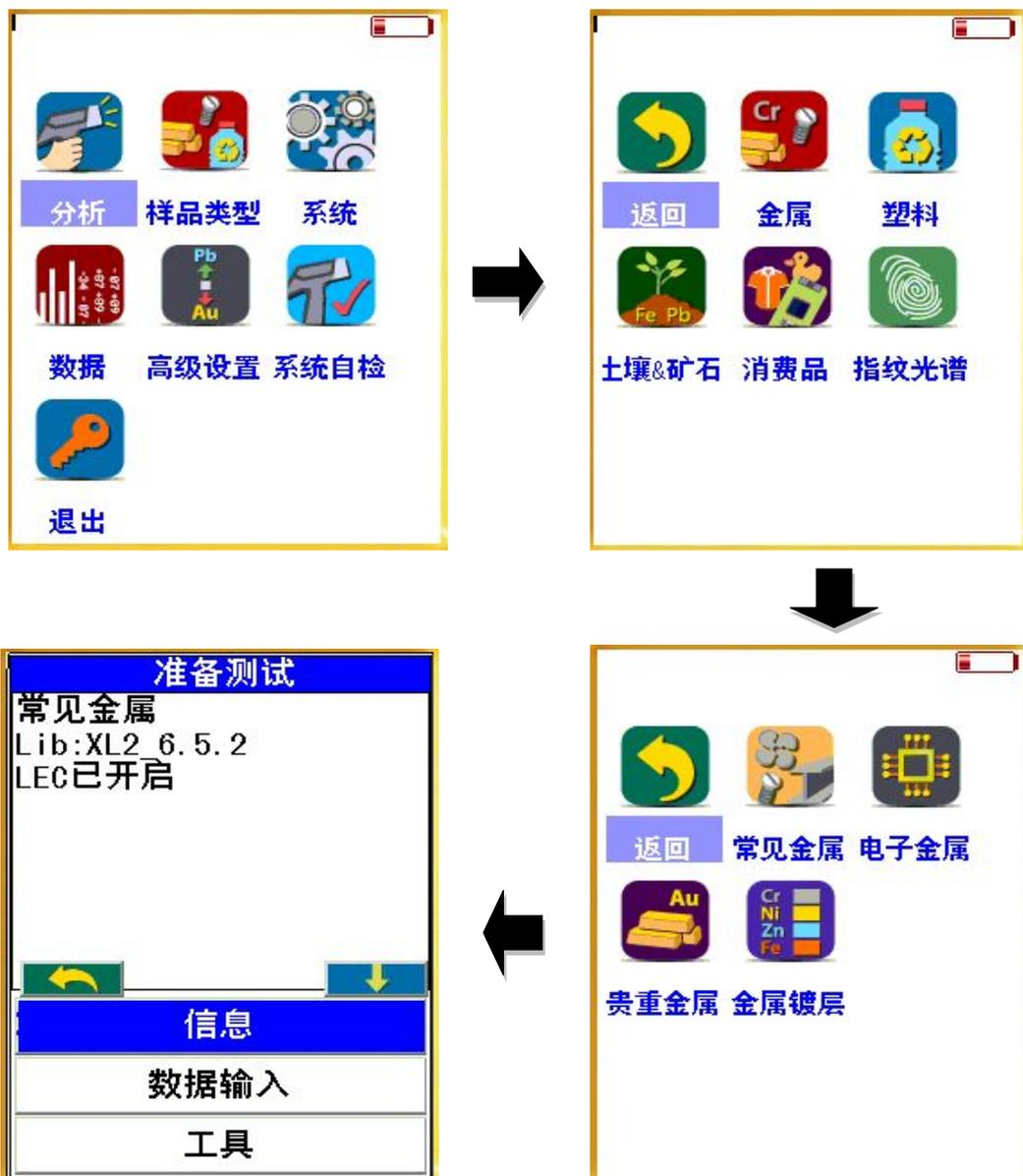
将被测样品置于测试窗口前，扣住触发扳机即开始测试，松开扳机测试结束。仪器将显示测试结果，每次测试结果仪器都会自动保存，测试结果显示如下图：
