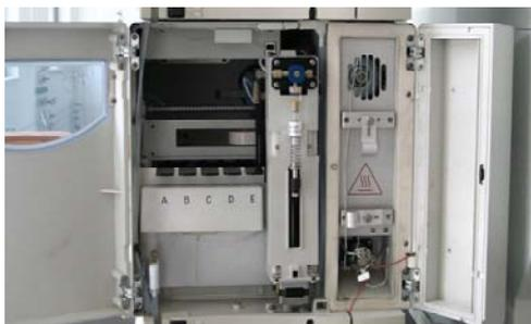
自动进样器的流路设计，每次进样后，进样针内侧、针座传输管、样品定量环由方法中设定的洗针溶剂 (Flush Volume) 来清洗，进样针外侧又方法中设定的洗针溶剂 (Wash Volume) 来清洗。
